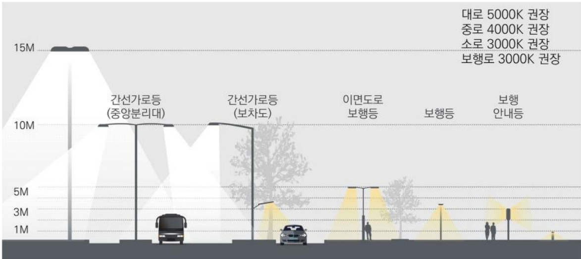
[그림5-10] 도로조명 설치 개념도
