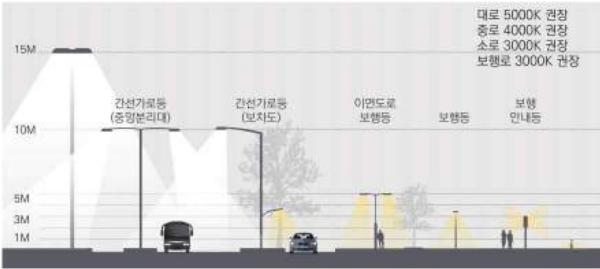
[그림5-10] 도로조명 설치 개념도
